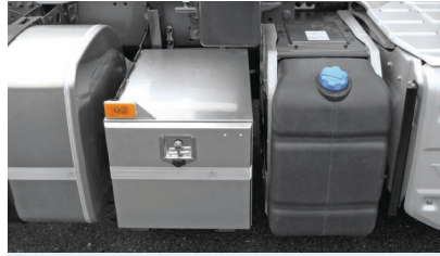
Werkzeugkasten (WZK) Edelstahl LxBxH 800/1000/1200x480x480 oder 600x600
