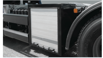
Werkzeugkasten (WZK) mit Rolladen
