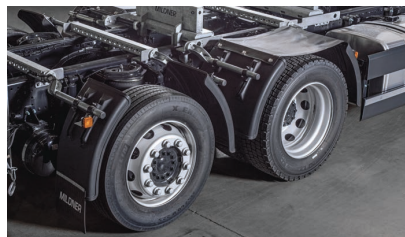
Kotflügel Viertelschale mit Planenabdeckung - alternativ Kunststoffplattenabdeckung
